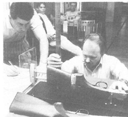
Måttbössan är inställd så att den passar Anders och har placerats i mätgiggen. Håkan tar de olika måtten och Jan antecknar.
